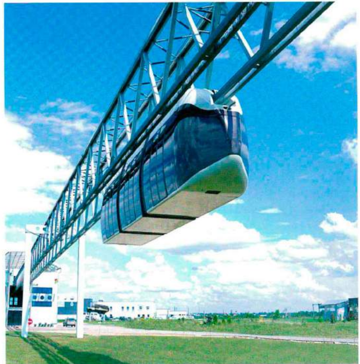
▲ Четыре тестовых участка инновационных дорог построены и функционируют в Марьиной Горке. Модулями управляет что-то вроде искусственного интеллекта, который уже разогнал их до 100 км/ч на участке около 1 км. В реальных условиях на больших отрезках они смогут развивать скорость до 150 км/ч в городской черте.
